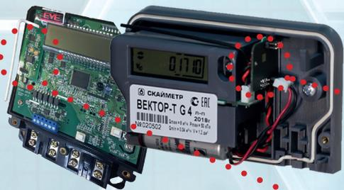
Радиоконтроллер устанавливается под крышкой корпуса счетчика (под пломбы изготовителя и поверителя)
